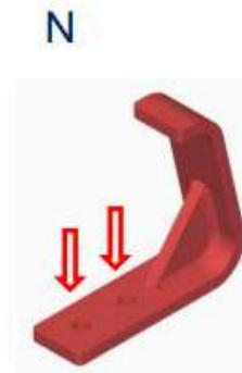
Realice la fijación del sistema de anclaje frontal (N), trasero (O) y el seguro de seguridad (P) con los herrajes disponibles en el kit que acompaña el producto. Utilice una llave hexagonal n° 13 y asegúrese de que los tornillos del sistema de fijación estén bien apretados.
